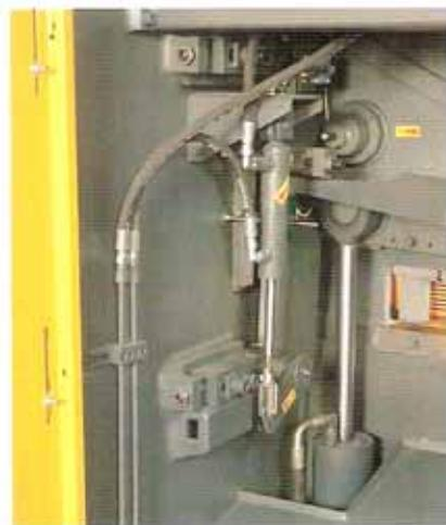
Automatické nastavenie strižnej vôle v závislosti od hrúbky materiálu pomocou 2 hydraulických valcov.
